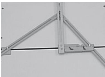
Figura 5 - Il parabolografo di Cavalieri
