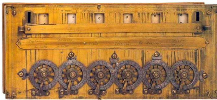
Figura 3 - Il lato superiore della Pascalina con le ruote usate dall'operatore per introdurre i numeri e le aperture in cui compariva il risultato
